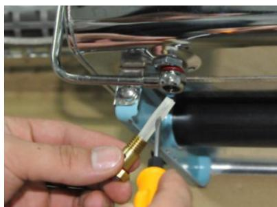
Для того чтобы слить препарат открутите крепления клапана, показано на рисунке.
