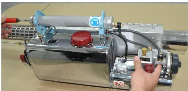
Держите палец в разъеме вытеснителя, и накачивайте воздух с помощью насоса, если вы чувствуете, что на палец попадает бензин, значит всё в порядке. Для того чтоб увеличить подачу бензина, увеличьте подачу бензина с помощью ручки мощности двигателя.
