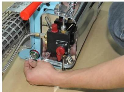
2. Проверьте систему зажигания, найдите на корпусе генератора кнопку, и нажмите на неё, если вы услышите характерные щелчки, значит система зажигания в порядке.
